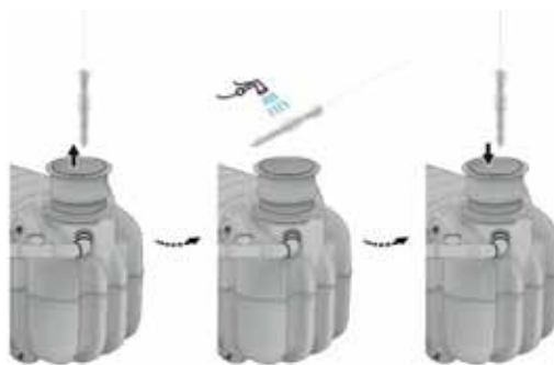
Fig. 55: Nettoyage du préfiltre
