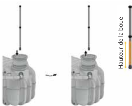
Fig. 63: Mesurer la hauteur de la boue dans la cuve de prétraitement
