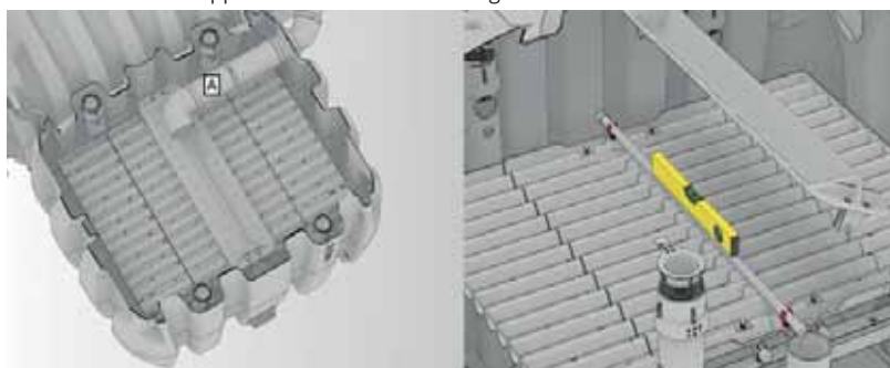
Fig. 57: Contrôler l'alignement de l'auget basculant et la planéité de son axe de support avec un niveau à bulles
