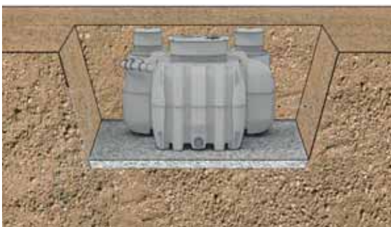
Fig. 30: Filtre en place - Terrain sec
