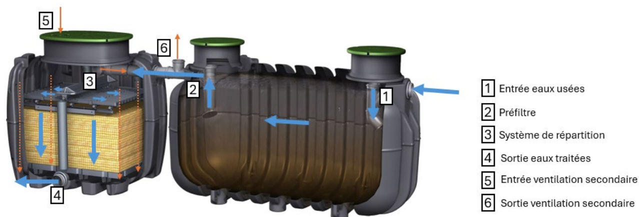
Fig. 49: Circulation de l'eau – Points de contrôle (flux hydraulique en bleu et flux d'air en orange)
